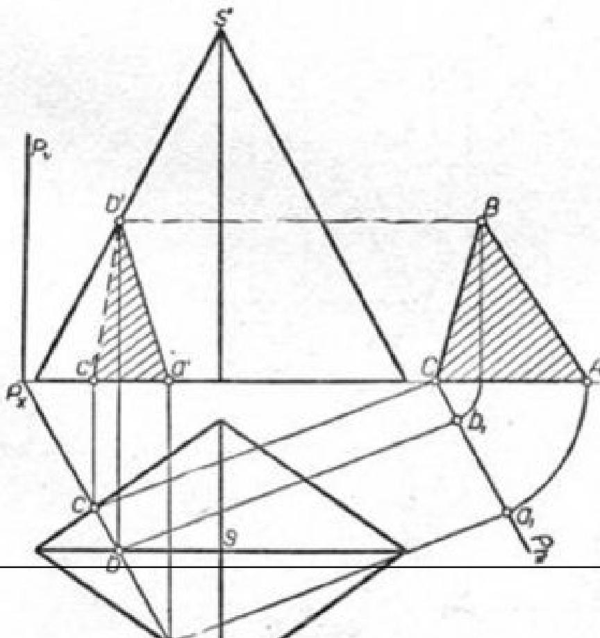
Задача: Построить истинную величину наклонного сечения. Дано: Наклонное сечение, заданное в виде отрезка прямой линии, параллельную
